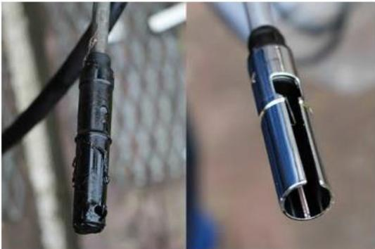
• Alt und neu im Vergleich: Während der Grenzwertgeber alter Bauart zwei Bohrungen in der Schutzhülse hat, ist beim neueren Modell ein Schlitz eingearbeitet, der weniger verschmutzungsanfällig ist. Foto: IWO
