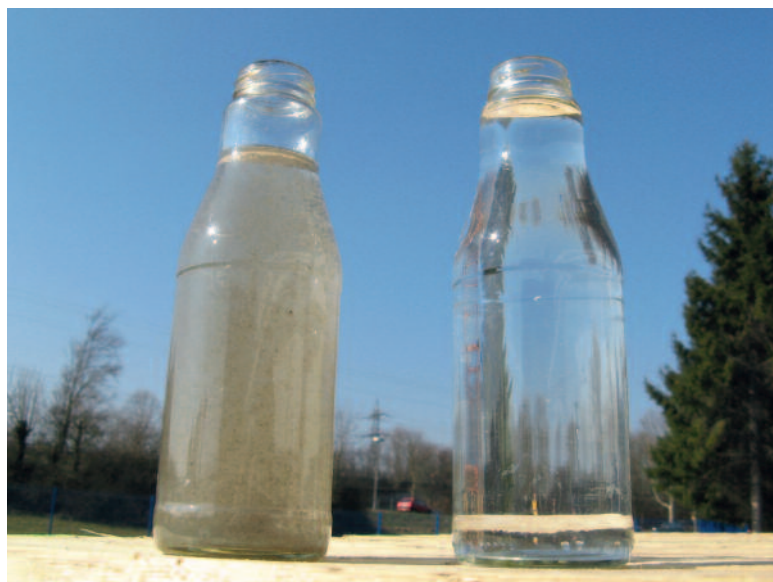
▲ Bild 5 • Optisch und sensorisch ist gereinigtes Grauwasser nicht von Trinkwasser zu unterscheiden. Links: Grauwasser vor der Aufbereitung. Rechts: Grauwasser nach der Aufbereitung.
