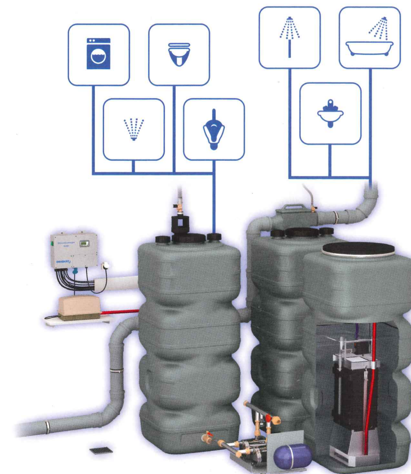
Funktion einer Grauwassernutzungsanlage auf Basis der Bio-Membran-Technologie (BMT): Abwasser von der Bade- beziehungsweise Duschwanne und dem Waschtisch – genannt Grauwasser – wird nach der Aufbereitung erneut im Gebäude verwendet. Zum Beispiel für die Toilettenspülung, Waschmaschine, Bewässerung oder Raumreinigung.
