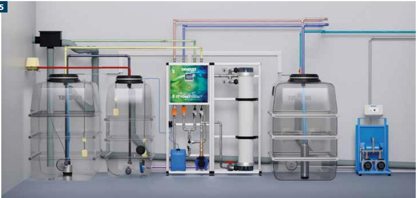
5 Anlagenbeispiel „GWtec“ 140 zur Behandlung von 3-7 m<sup>3</sup> Grauwasser pro Tag. Die Aufbereitung erfolgt in mehreren Schritten, durch aerobische Filtration werden organische Schmutzpartikel ohne den Einsatz von Chemie abgebaut. Membranfilter reinigen das vorbehandelte Grauwasser. Die Anlage mit trockenstehenden Membranfiltern speist aufbereitetes Grauwasser ins Betriebswassernetz.
