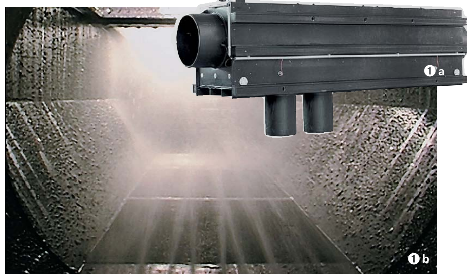
① Der Industrie-Filter der C-Class von GEP (Bild 1 a) eignet sich neben der Regenwassernutzung auch für technische Wässer. Das patentierte Wirkprinzip realisiert eine nahezu vollständige und vollautomatische Reinigung der Filterflächen bei sinkender Filterleistung (Bild 1 b). Die besondere druckfeste Bauart ermöglicht eine Montage ohne Höhenversatz zwischen Zu- und Ablauf.
