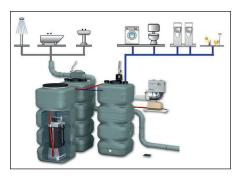
Fließschema einer GEP-Grauwasseranlage. Das Grauwasser wird erfasst (grau), aufbereitet und als Betriebswasser (blau) wieder verwendet.
