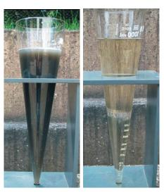
Optisch und sensorisch ist Betriebswasser von Trinkwasser nicht zu unterscheiden. Links: Grauwasser vor dem Aufbereitungsprozess; Rechts: Grauwasser nach dem Aufbereitungsprozess
