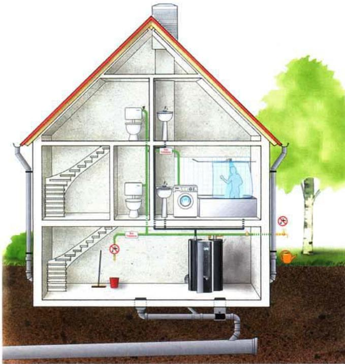
Mit der Grauwasser-Aufbereitungsanlage WME-4 wird Klarwasser erzeugt, das den Anforderungen an Badewasser gemäß EU Richtlinie entspricht und für WC-Spülung, Waschmaschine und Gartenbewässerung zur Verfügung steht.
