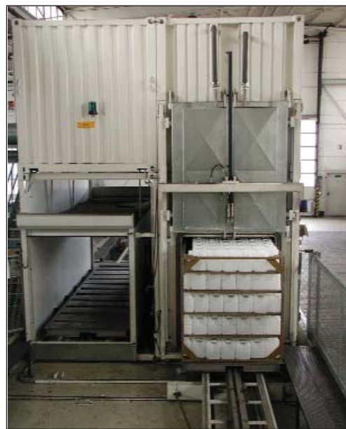
Für den Fluorierungsprozess werden beliebig viele Behälter auf Stellagen in die Kammer eingebracht Foto: Dehoust
