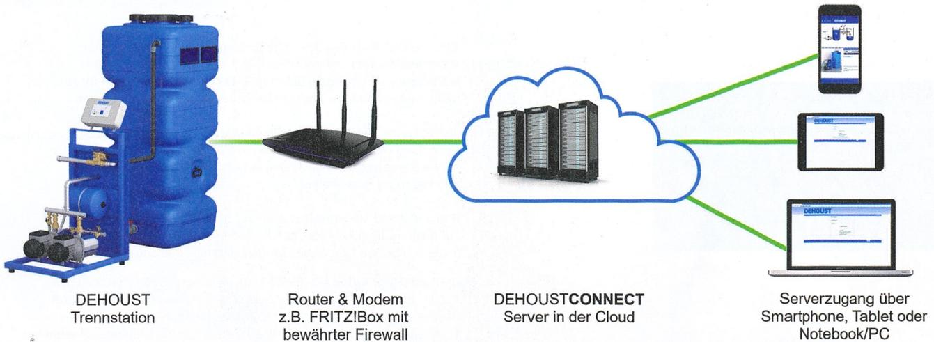
Oben: Das Konzept von „DehoustConnect“ im Überblick: Der Server des Herstellers als Cloud sowie die spezielle Datenübertragung sorgen dabei für ein Höchstmaß an Datensicherheit. (Fotos + Grafik: Dehoust)
