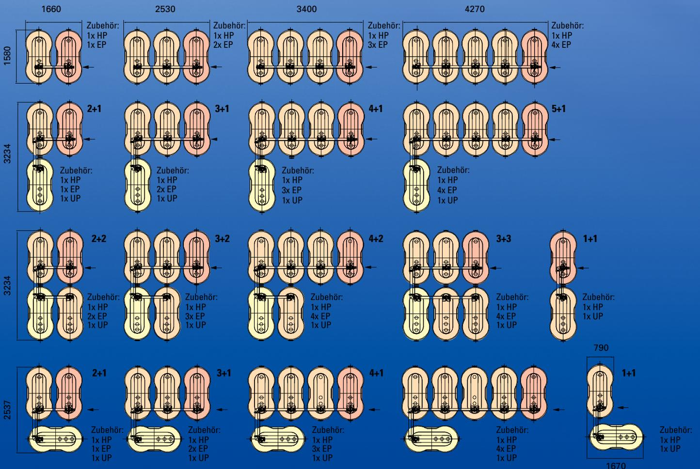
Bei den Varianten 2+2, 3+2, 4+2 und 3+3 fordert die ab 50 cm Deckenabstand, sollte der Deckenabstand nicht vorhanden sein, müssen bei diesen Varianten an beiden Längsseiten 40 cm Abstand sein; die L-Varianten gelten als einreihig.
