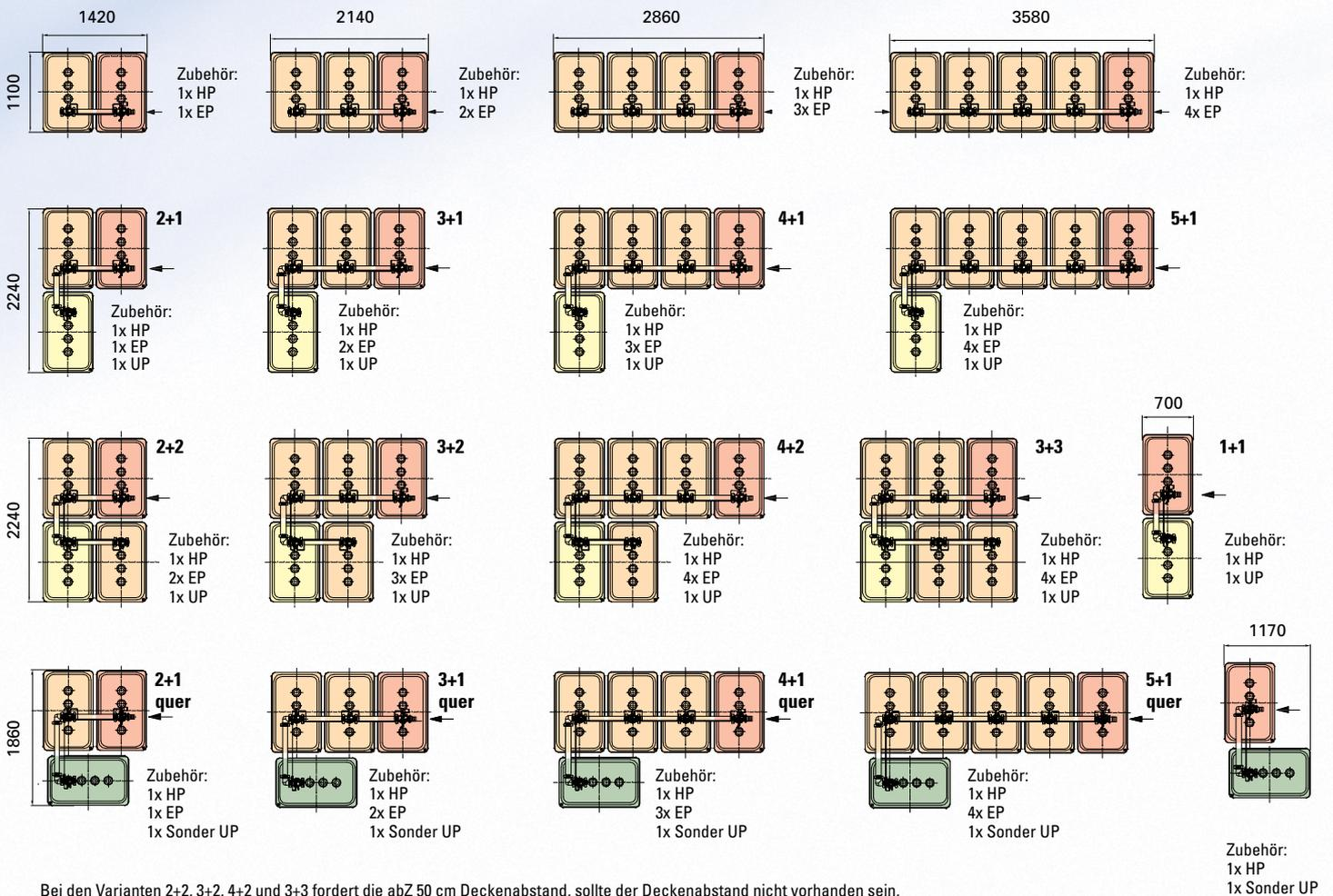
Bei den Varianten 2+2, 3+2, 4+2 und 3+3 fordert die abZ 50 cm Deckenabstand, sollte der Deckenabstand nicht vorhanden sein, müssen bei diesen Varianten an beiden Längsseiten 40 cm Abstand sein; die L-Varianten gelten als einreihig.
