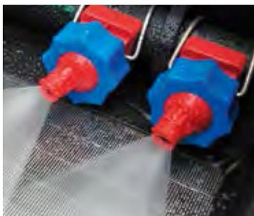
Spezielle Sprühdüsen halten die Siebfläche sauber und sorgen so für lange Wartungszyklen.
