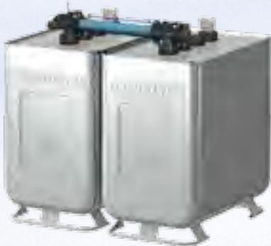
Der PE-Kombi Tank besteht aus einem Innenbehälter PE-Plus und einem verzinkten Außenbehälter, die einzeln auf Dichtheit geprüft werden. Mit jedem Behälter wird ein Leckageerkennungssystem und ein Tankinhaltsanzeiger mitgeliefert. Die idealen Einbringmaße von 700 mm erleichtern den Einsatz bei Sanierungen.
