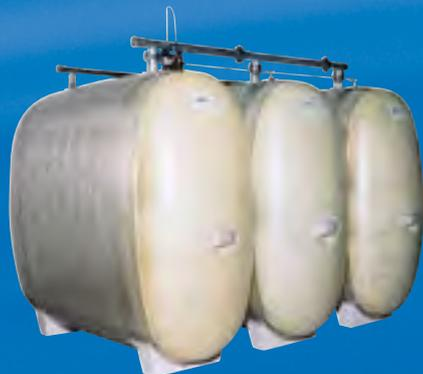
Umstellung lohnt sich! Für einwandige GFK-Tanks bieten wir ein nichtkommunizierendes Entnahmesystem mit zusätzlichen Vorteilen: Die Grenzwertgeberkette überwacht jeden Tank bei der Befüllung und verhindert ein Überfüllen durch ungleichmäßige Füllstände; die Schwimmende Entnahme sorgt dafür, dass im normalen Betrieb kein Schlamm durch den Brenner angesaugt wird.
