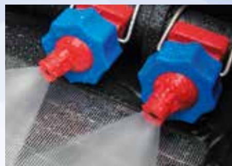
Spezielle Sprühdüsen halten die Siebfläche sauber und sorgen so für lange Wartungszyklen.
