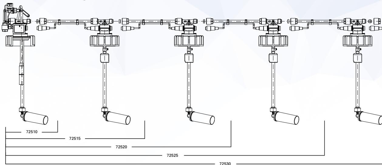
Bei Einsatz dieses Entnahmesystems NK muss die Saugleitung zum Brenner auf Einstrang umgestellt werden.
