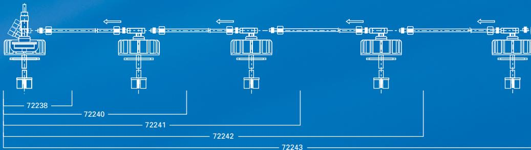
Die Entnahmeleitung  $\varnothing$  8 mm eignet sich für alle PE-Batterietanks 1.000-2.000 l (Bandagentanks) von DEHOUST, Kautex ab Baujahr 1972 sowie die bandagenlosen Trio-Tanks 1.100-2.000 l und viele andere PE-Tanks.
