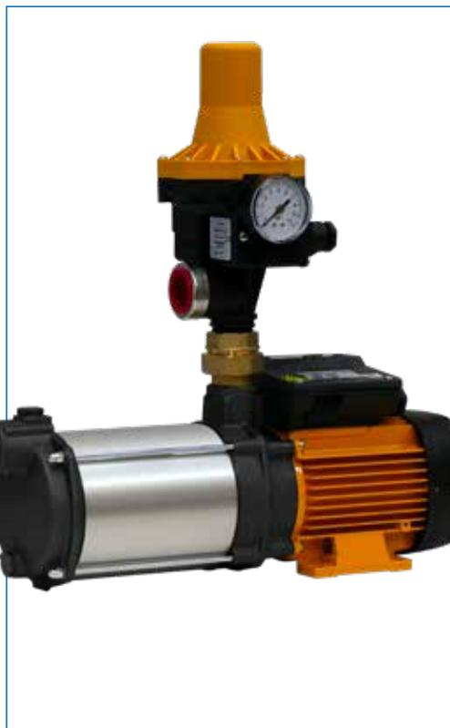
Das Hauswasserwerk Aspri aus Grauguss ist eine hochwertige, speziell für die Regenwassernutzung entwickelte, selbstansaugende, mehrstufige, horizontale Kreiselpumpe. Sie zeichnet sich durch einen hohen Wirkungsgrad aus und ist für Dauerbetrieb geeignet. Das Hauswasserwerk ist mit einem Durchflusswächter Kit 02 zum automatischen Betrieb der Pumpe ausgestattet. Das enthaltene Manometer zeigt wichtige Informationen zum aktuellen Druck.
