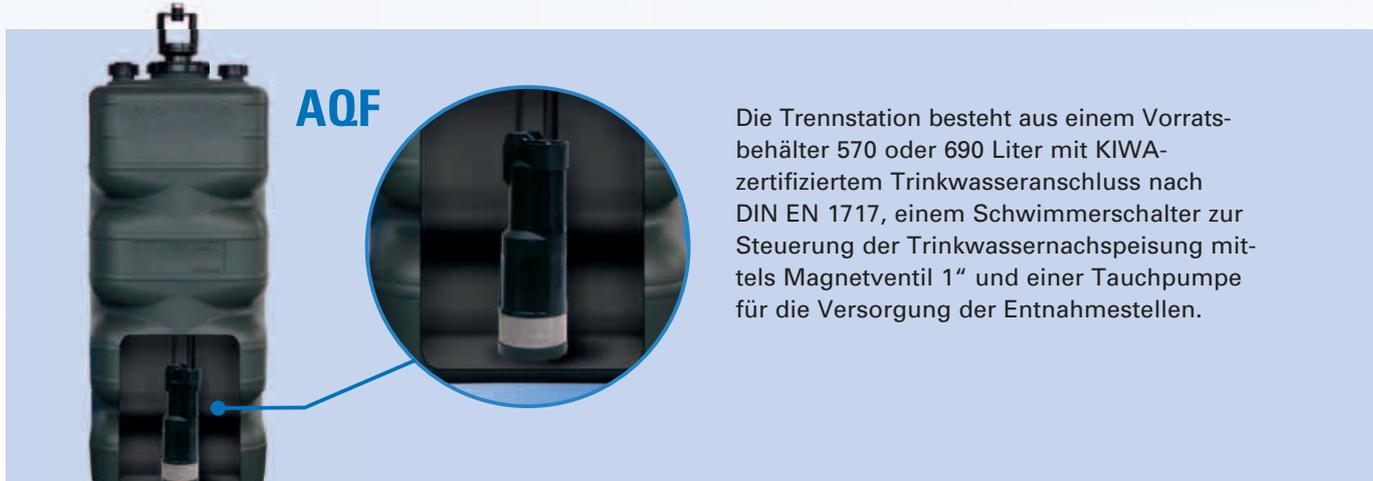
Die Trennstation besteht aus einem Vorratsbehälter 570 oder 690 Liter mit KIWA-zertifiziertem Trinkwasseranschluss nach DIN EN 1717, einem Schwimmerschalter zur Steuerung der Trinkwassernachspeisung mittels Magnetventil 1" und einer Tauchpumpe für die Versorgung der Entnahmestellen.
