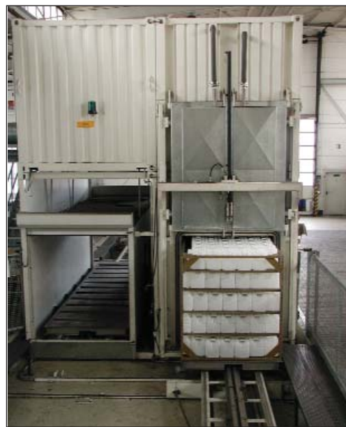
Für den Fluorierungsprozess werden beliebig viele Behälter auf Stellagen in die Kammer eingebracht
