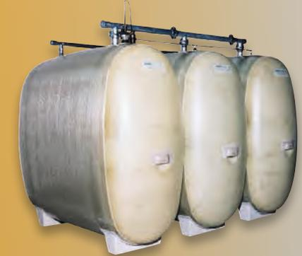
Einwandige GFK-Tanks sind meist ohne bauseitige Auffangwanne aufgestellt. Umso wichtiger ist das Vermeiden von Überfüllungen. Hier bietet das Servicepaket Schwimmende Entnahme NK mit Gewinde 1 1/2" und 2" und Grenzwertgeberkette die optimale Lösung. Die GWG-Kette bringt eine zusätzliche Sicherheit beim Befüllen der Tankanlage.
