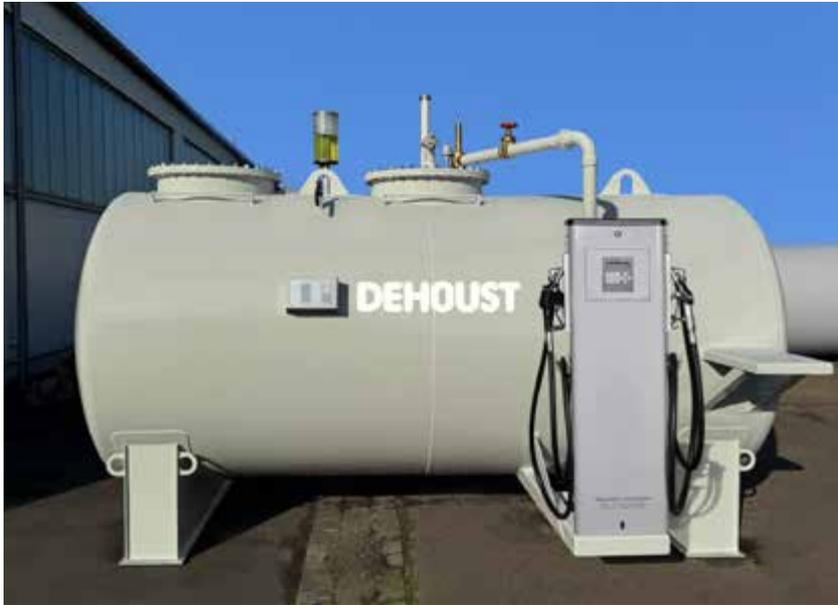
Betriebstankstellen mit doppelwandigen Stahlbehältern nach EN 12285-2 bis zu 150 m<sup>3</sup>, vorgerüstet für Zapfsäulen für flüssige Betriebsstoffe – auch als Mehrkammerbehälter zur Bevorratung unterschiedlicher Kraftstoffe (z.B. Winterdiesel).
