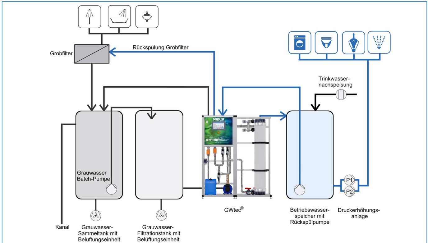
In einem mehrstufigen Aufbereitungsverfahren wird das gesammelte Grauwasser zuerst einer biologischen Reinigung unterzogen und im Anschluss mit der DEHOUST GWtec®-Membranfiltration von den restlichen Schmutzpartikeln befreit.
