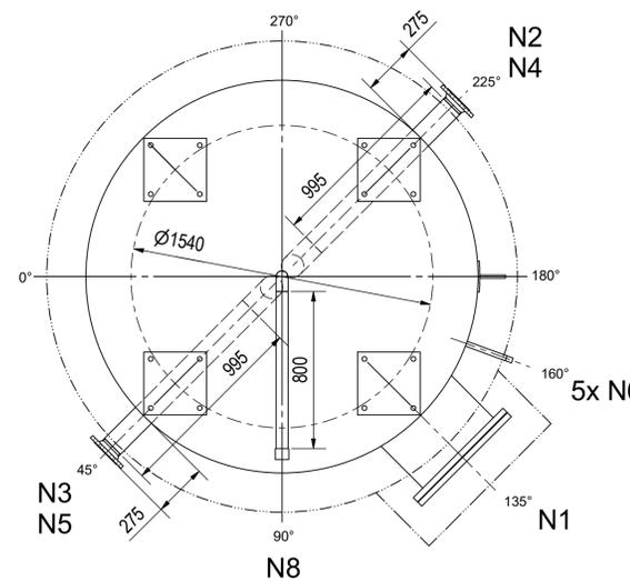
**Hinweise** Die Auslegung von Fundament und Verankerung erfolgt bauseits. Die Eignung von Untergrund und Fundament ist bauseits zu prüfen. Die Tragkonstruktion ist ggf. bei Aufstellung zu unterfüttern. Der Behälter ist spannungsfrei anzuschließen. Die Gewichtangaben können aufgrund Toleranzen etc. abweichen. Für den Transport ist eine Reserve (min. 10%) einzuplanen.
