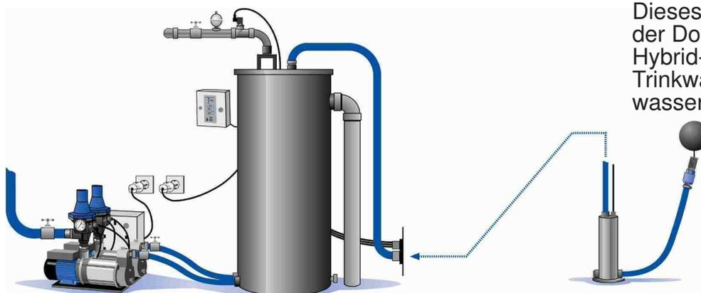
Dieses Schema zeigt die Kombination der Doppelpumpenanlage mit einem Hybrid-System zur bedarfsgerechten Trinkwassernachspeisung bei Regenwassermangel im Auffangbehälter.
