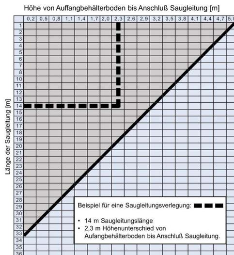
Die Tabelle links stellt das Verhältnis Länge der Saugleitung zu Höhe vom Auffangbehälterboden (z. B. Zisterne/ Erdbehälter) bis Anschluss-Saugleitung dar. Bei Installation der Saugleitung ist eine möglichst geringe Höhen- und Längendifferenz einzuhalten.
