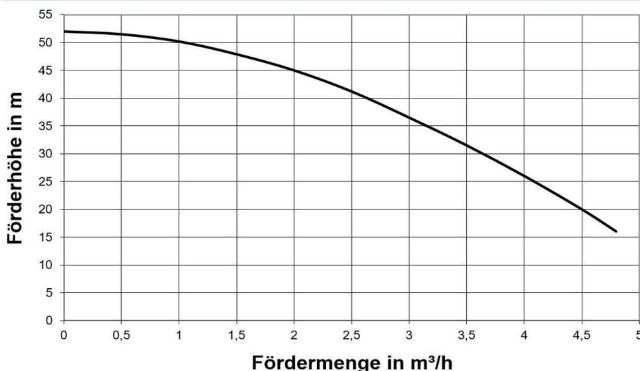
Diese Übersicht basiert auf einer kinematischen Viskosität von 1 mm²/s und einer Dichte von 1.000 kg/m³.
