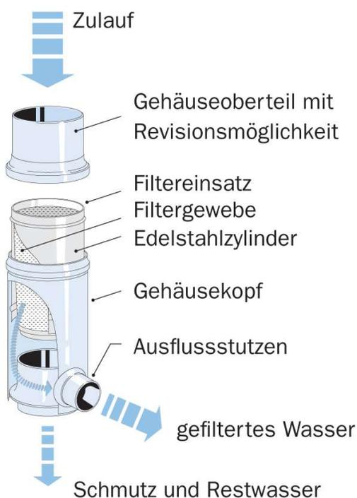
Der Fallrohrfilter für Dachflächen bis 130 m<sup>2</sup> wird in das Fallrohr eingebaut und leitet das saubere Regenwasser über einen seitlichen Stutzen zum Regenwasserspeicher ab, während das Schmutzwasser weiter im Fallrohr herunterfällt. Der feinmaschige Edelstahl-Filtereinsatz sorgt für eine sehr gute Wasserqualität.
