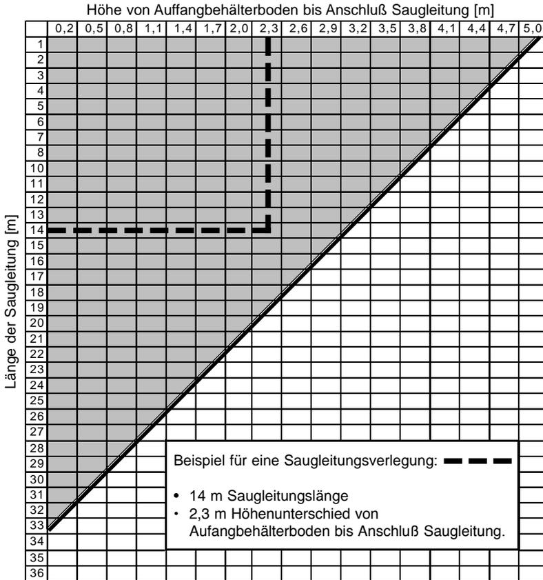
**i** Die Tabelle stellt das Verhältnis Länge der Saugleitung zu Höhe vom Auffangbehälterboden (z. B. Zisterne/ Erdbehälter) bis Anschluß-Saugleitung dar. Bei Installation der Saugleitung ist eine möglichst geringe Höhen- und Längendifferenz einzuhalten.
