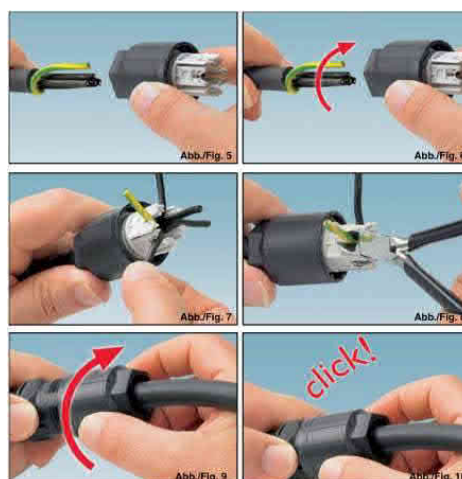
Abbildung 9: Anschluss Netzleitung der Zubringerpumpe an Quickon-Stecker
