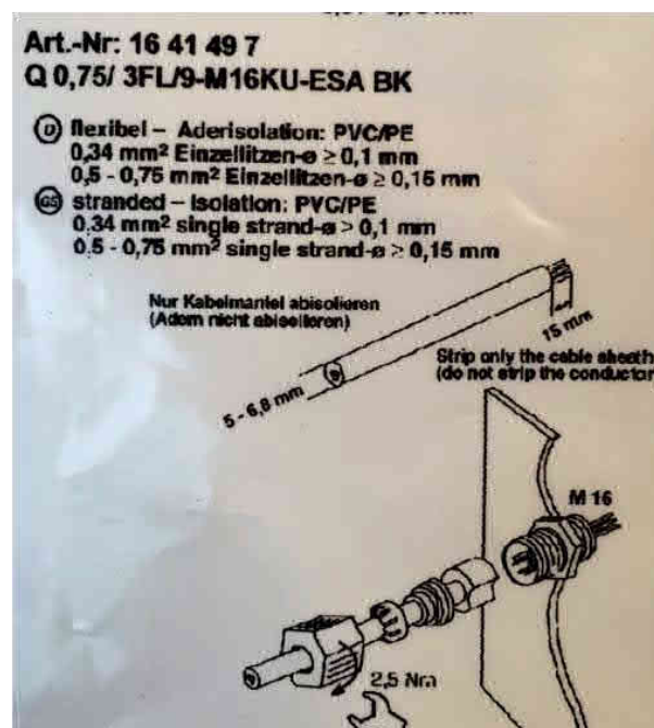
Abbildung 15: Anschluss der Alarmkontakt-Kabelleitung am Steckkontakt
