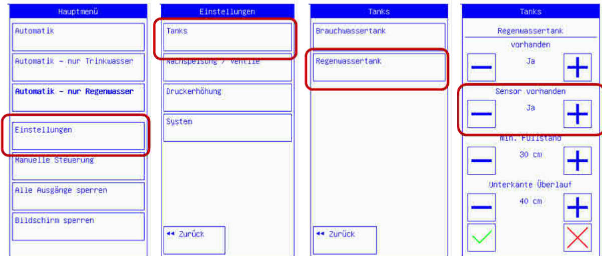
Abbildung 48: Freischalten des Sensors zur Visualisierung des Füllstandes
