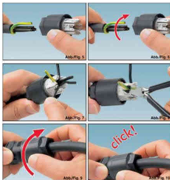
Abbildung 43: Elektrischer Anschluss der Netzleitung mit der Quickon-Mutter des H-Verteilers
