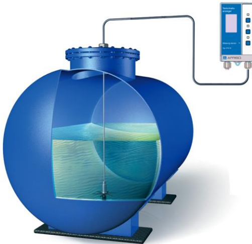
Bild 2: Anwendungsbeispiel digitaler Tankinhaltsanzeiger DTA 10
