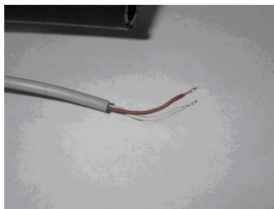
Das Steuerkabel kann gekürzt und hiernach mit der Systemsteuerung verbunden werden. Je eins, der zwei abisolierten Enden des Kabels in einen Klemmkontakt des Gerätes einführen. Die farbliche Belegung hat keine Relevanz.
