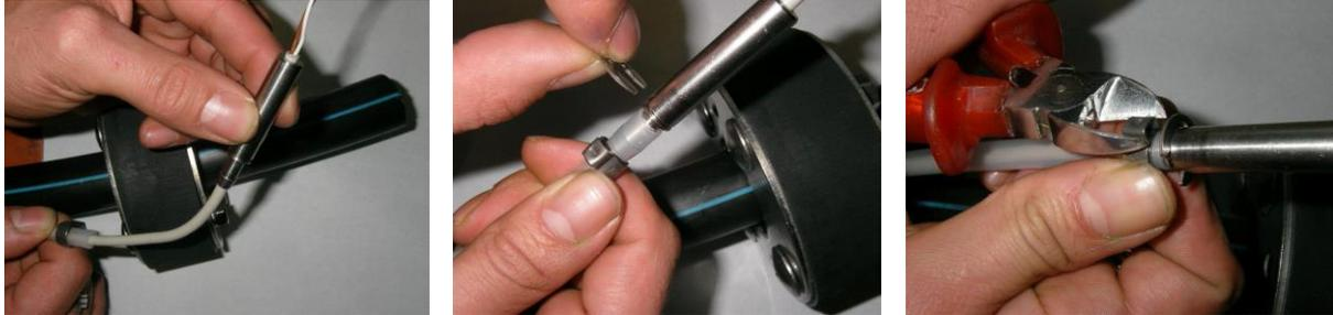
Das Edelstahlrohr wird so aufgeschoben, dass die Schlauchtülle zum Schlauch zeigt. Nachdem der Schlauch bündig auf die Schlauchtülle aufgeschoben wurde, wird der Sprengring auf das Edelstahlrohr gesteckt. Die Schlauchschelle wird auf die Schlauchtülle geschoben und mit einer geeigneten Zange verquetscht.
