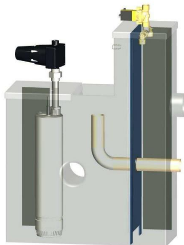
Abbildung 5: Tauchdruckpumpe mit DIGIMATIC im Vorratsbehälter
