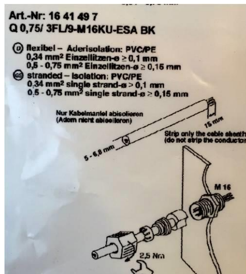
Abbildung 10: Anschluss der Füllstandskabelleitung am Steckkontakt
