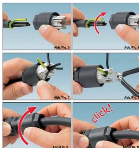
Abbildung 55: Elektrischer Anschluss der Netzleitung mit der Quickon-Mutter des H-Verteilers
