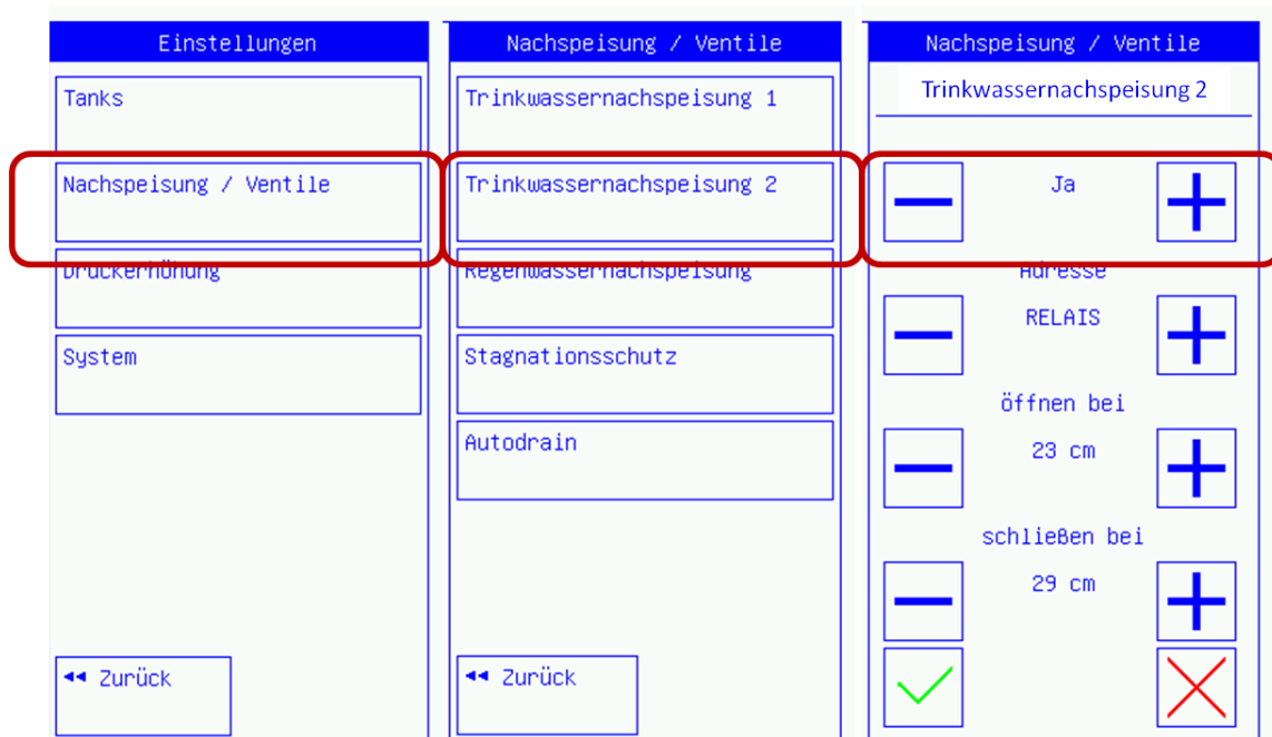
Abbildung 52: Einstellungen für die Trinkwassernachspeisung 2
