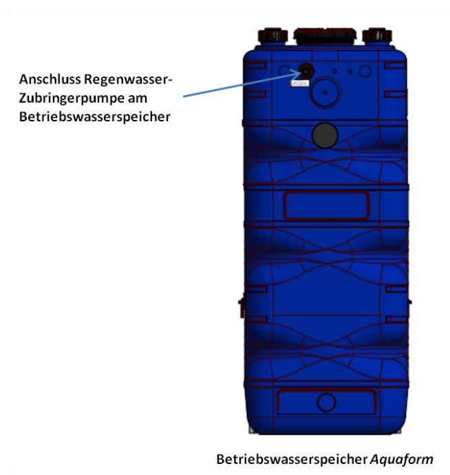
Abbildung 8: Anschluss der Zubringerrohrleitung am Betriebswasserspeicher
