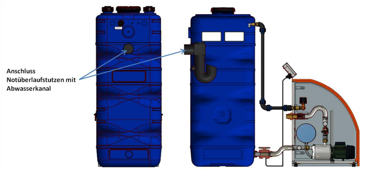
Abbildung 50: Anschluss des Notüberlaufstutzens am zusätzlichen Betriebswasserspeichers
