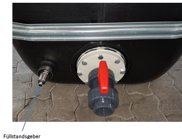
Abbildung 9: Kabelkopf mit Füllstandsgeber am Sicherheitstrennbehälter fest verbinden
