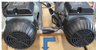
Abbildung 7: Positionieren des Feuchtigkeitsdetektors
