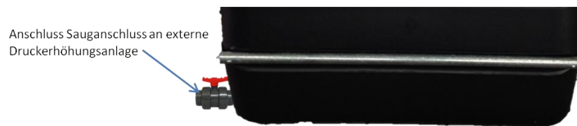
Abbildung 3: Sauganschluss mithilfe PVC-Ablasshahn herstellen
