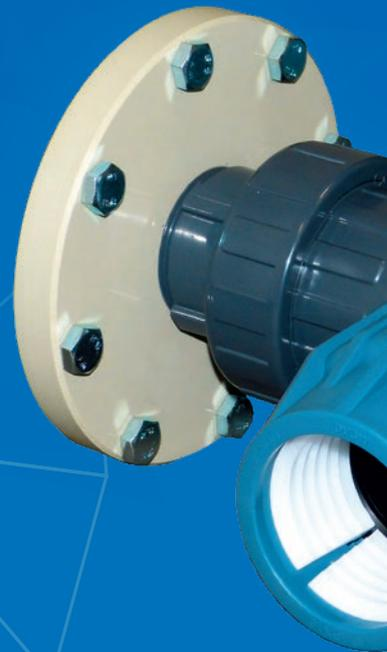
Die untere Verbindungsleitung DF ist für PE-Lagerbehälter mit Dom und Flansch von 1.100 - 4.000 Litern geeignet. Die Verbindungsleitung ist für bauseitigen Anschluss PE-Rohr DN 50 oder Schlauch D = 63 mm konzipiert.
