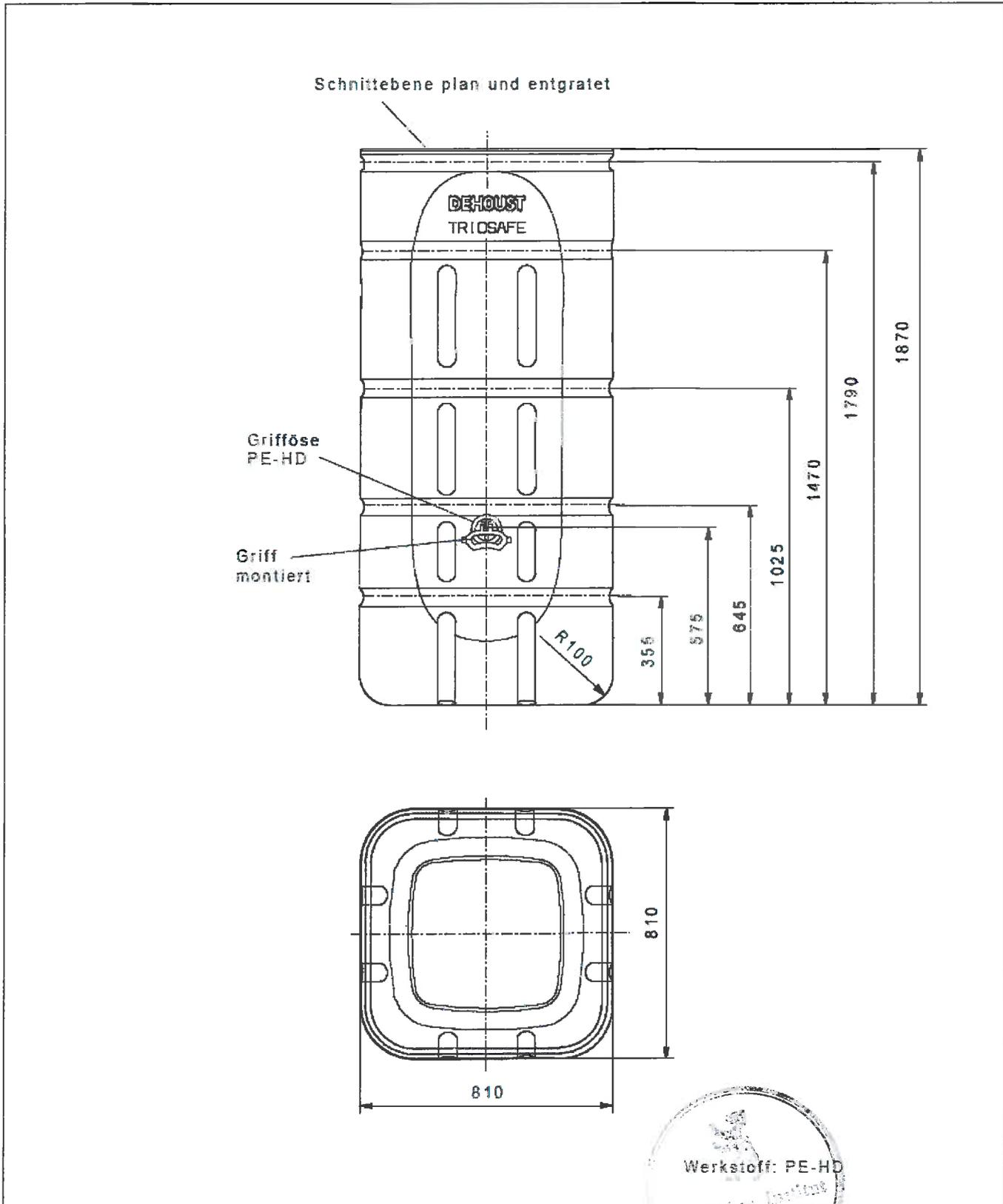
Blasgeformte Behälter mit integrierter Auffangvorrichtung
