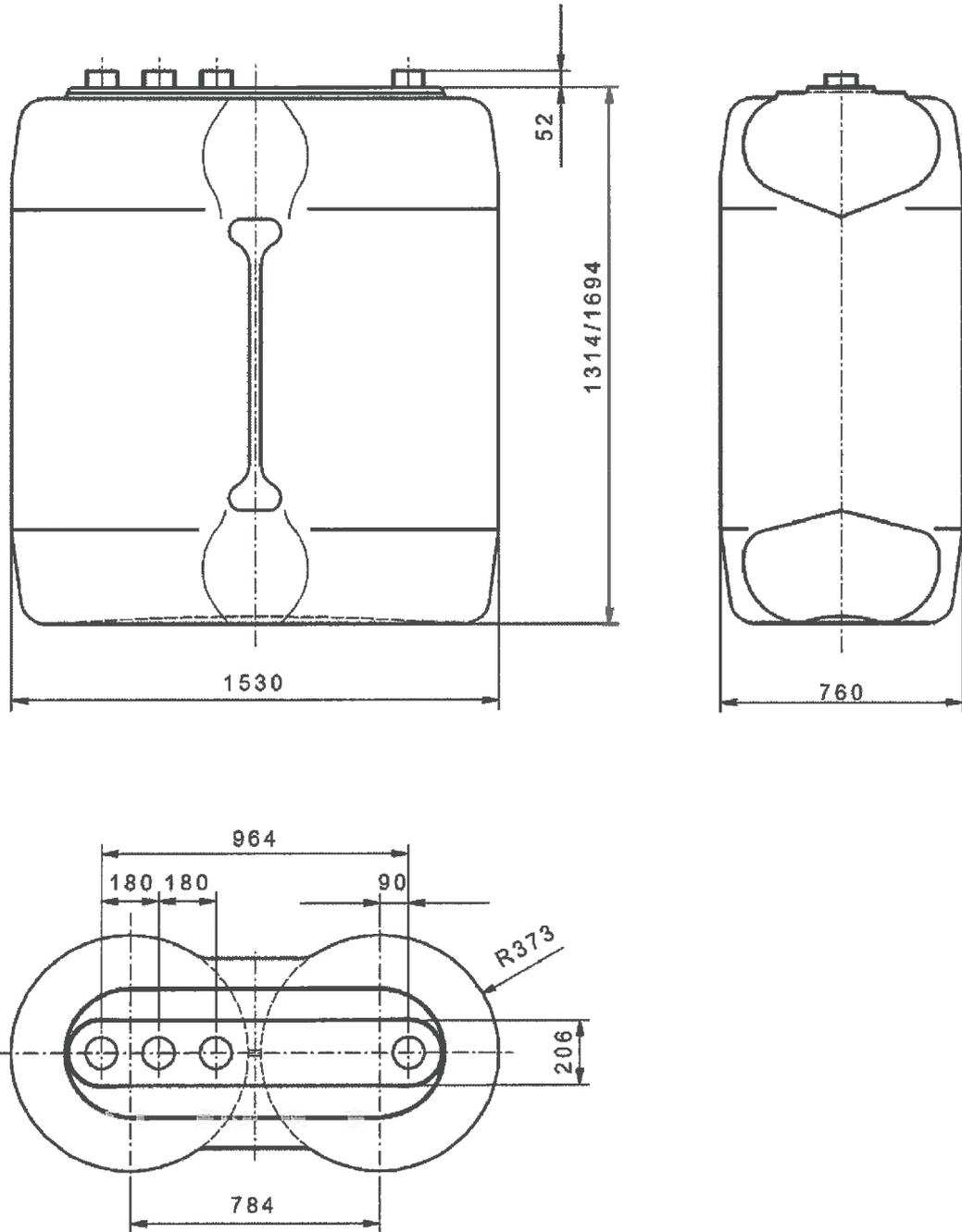
Blasgeformte Behälter mit integrierter Auffangvorrichtung
