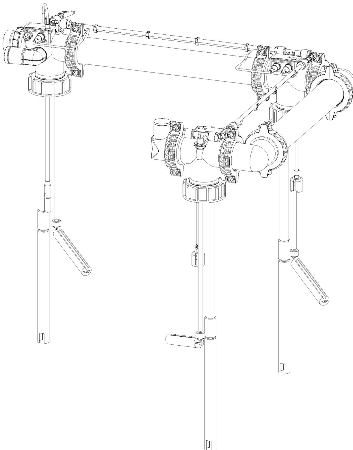
Befüllsystem "DE-A-01" mit integrierter Entlüftung und Entnahmeleitung für Heizölbehältersysteme
